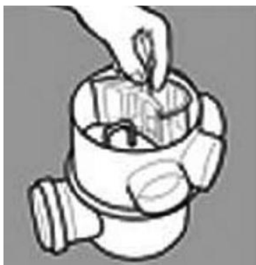
Remoção do cesto de limpeza
