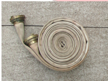
Foto 2: Mangueira aduchada corretamente
